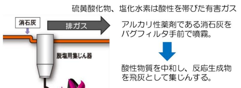
酸性物質を中和し、反応生成物を飛灰として集じんする。
