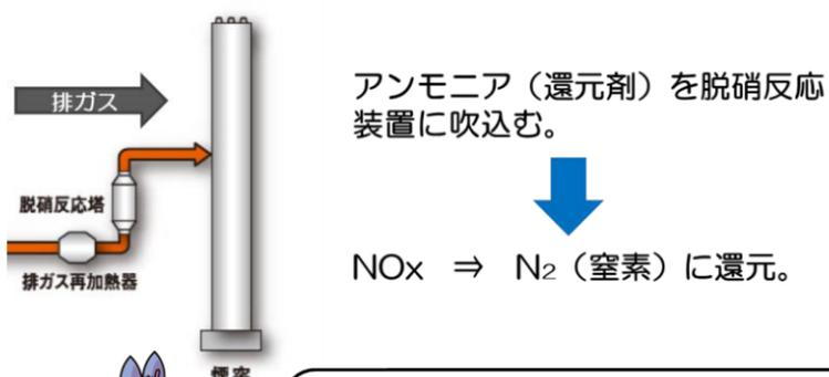
アンモニア（還元剤）を脱硝反応装置に吹込む。
