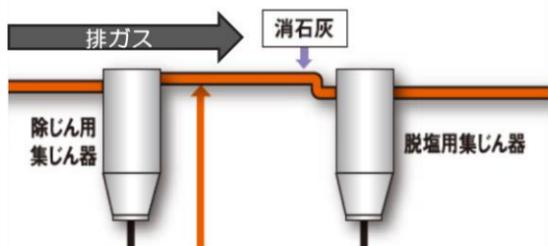
ろ布（フィルタ）の表面に堆積した粒子層でばいじん、水銀を捕集し、払落とす。
